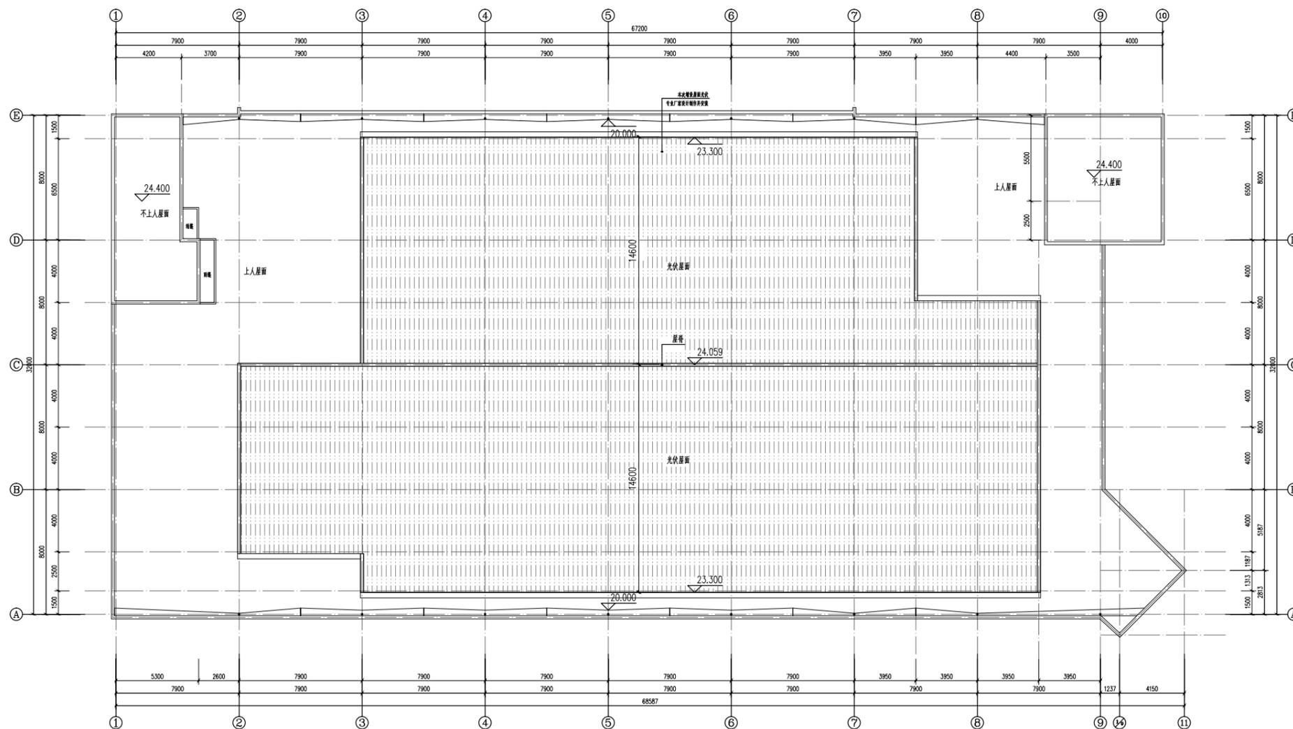
厂房屋顶分布式光伏设施 屋面平面图 1:100
